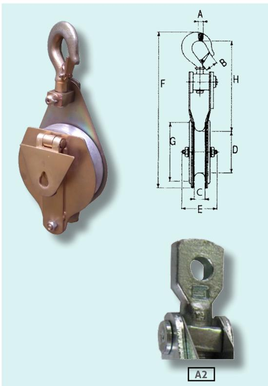
Polea de servicio con apertura lateral. Rueda de aluminio montada sobre cojinetes de bolas. Chasis de acero galvanizado con apertura lateral. Conector estándar con gancho de acero con seguro.
