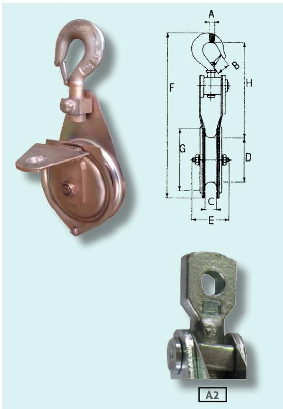
Polea de servicio con abertura lateral. Rueda de acero galvanizado montada sobre cojinetes de bolas. Chasis de acero galvanizado con abertura lateral. Conector estándar con gancho y seguro.
