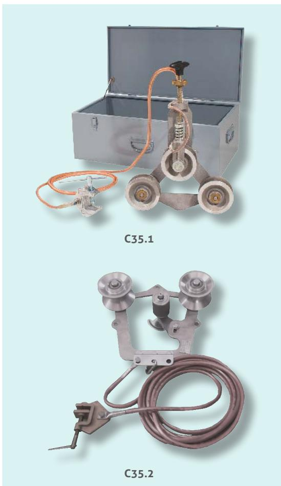
Dispositivo para la puesta a tierra durante el tendido de conductores desnudos aéreos o cables de tiro de acero. Las poleas de aleación de aluminio con cojinetes de bronce incorporados aseguran un buen deslizamiento y continuidad eléctrica. Resorte de compensación con rodillo regulable para un contacto seguro aún sobre conductores con empalmes.
