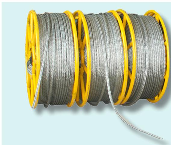
Fune antigirevole in acciaio zincato appositamente studiata per operazioni di tesatura. Costruzione a 12 trefoli intrecciati. Elevato carico di rottura, sicurezza, antigirevolezza, flessibilità e facilità di maneggio. Contatto lineare dei fili nelle zone di intreccio, che comporta un minore stress della fune. Fornita con asole impalmate alle estremità, avvolta su bobine metalliche o in legno.
