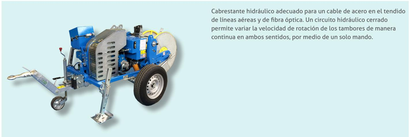
Cabrestante hidráulico adecuado para un cable de acero en el tendido de líneas aéreas y de fibra óptica. Un circuito hidráulico cerrado permite variar la velocidad de rotación de los tambores de manera continua en ambos sentidos, por medio de un solo mando.
