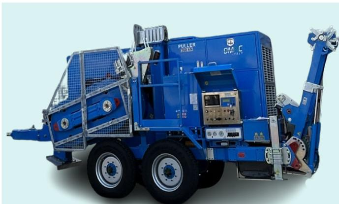
Cabrestante hidráulico adecuado para un cable de acero en el tendido de líneas aéreas. Un circuito hidráulico cerrado permite variar de manera continua la velocidad en ambos sentidos actuando sobre un único mando.
