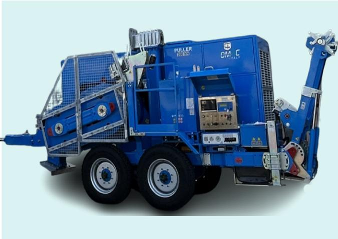
Treuil hydraulique conçu pour le tirage d'une câblette dans le déroulage de lignes électriques de transport aériennes. Un circuit hydraulique fermé permet de varier en continu la vitesse de rotation des cabestans dans les deux directions en agissant sur un seul dispositif de contrôle.
