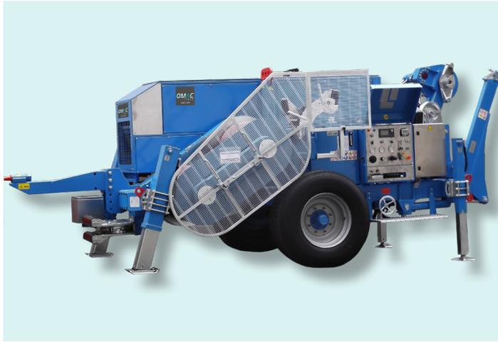
Cabrestante hidráulico adecuado para un cable de acero en el tendido de líneas aéreas. Un circuito hidráulico cerrado permite variar de manera continua la velocidad en ambos sentidos actuando sobre un único mando.
