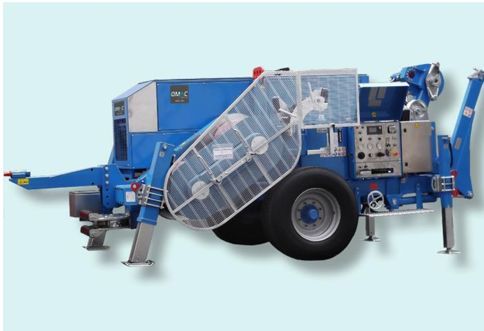
Treuil hydraulique conçu pour le tirage d'une câblette dans le déroulage de lignes électriques de transport aériennes. Un circuit hydraulique fermé permet de varier en continu la vitesse de rotation des cabestans dans les deux directions en agissant sur un seul dispositif de contrôle.
