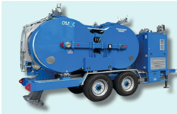
Freineuse hydraulique conçue pour l'installation d'un, deux, trois ou quatre conducteurs (jusqu'à six sur demande). Deux circuits hydrauliques permettent d'appliquer une force de freinage constante même à la variation de la vitesse de déroulage.
