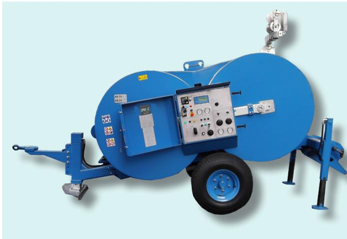
Máquina hidráulica que permite trabajar tanto como frenadora como cabrestante, adecuada para tensar uno o dos conductores. Un circuito hidráulico permite ejecutar una fuerza de frenado constante aún al variar de la velocidad de tendido. En función cabrestante, el circuito hidráulico cerrado permite variar de manera continua la velocidad en ambos sentidos de rotación de los tambores.
