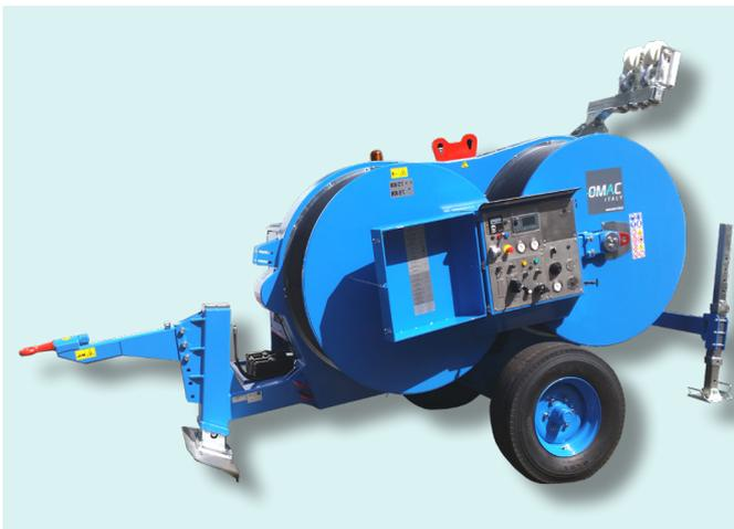
Máquina hidráulica que permite trabajar tanto como frenadora como cabrestante, adecuada para tensar uno o dos conductores. Un circuito hidráulico permite ejecutar una fuerza de frenado constante aún al variar de la velocidad de tendido.
