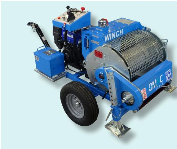
Cabrestante hidráulico, adecuado para el tiro de un cable durante operaciones de servicio, como montajes, regulaciones, y tendido de cables subterráneos. Un circuito hidráulico cerrado permite variar la velocidad de manera continua en ambos sentidos, por medio de un único mando.
