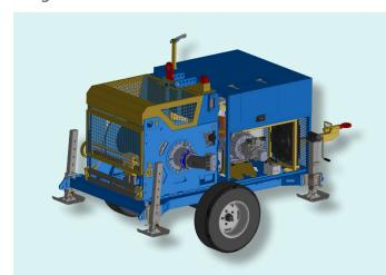
Treuil hydraulique conçu pour le tirage d'une câblette au cours des opérations de service telles que les montages, les régulations et la pose de câbles souterrains. Tirage direct sur le tambour. Un circuit hydraulique fermé permet la variation continue de la vitesse dans les deux sens de rotation à travers un seul levier de commande.
