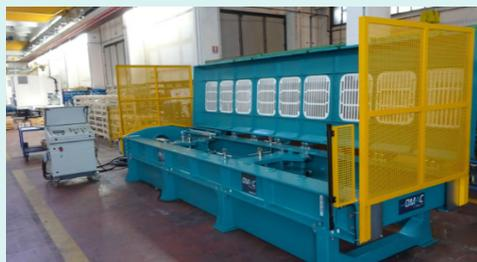
Banco di trazione progettato per testare e verificare la resistenza alla trazione (forza di rottura) di qualsiasi pezzo o gruppo.
