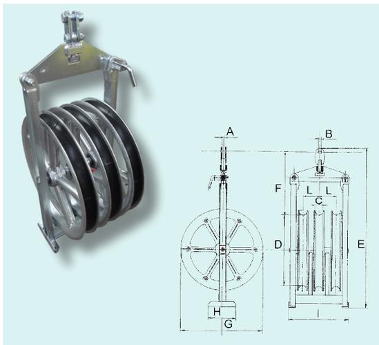
Châssis à trois réas adapté pour le déroulage de conducteurs à double/triple faisceau. Réas aluminium montés sur roulements à billes blindés. Gorges recouvertes par secteurs nylon. Châssis en acier galvanisé muni de dispositif anti-basculement sur les réas latéraux. Attelage démontable pivotant à 90° (disponible avec roues rapprochées).
