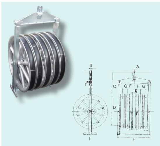
Châssis à cinq réas adapté pour le déroulage de conducteurs à quadruple faisceau. Réas aluminium montés sur roulements à billes blindés. Gorges recouvertes par secteurs nylon. Cadre en acier galvanisé muni de dispositif anti-basculement sur les réas latéraux. Attelage démontable pivotant à 90° (disponible avec roues rapprochées).
