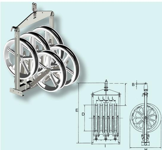
Polea descomponible de 5 ruedas para tendido de 4 conductores. El bastidor contiene 5 poleas que se pueden utilizar de forma individual. Ruedas de aluminio fundido montadas sobre cojinetes protegidos. Gargantas recubiertas por sectores nylon. Bastidor de acero galvanizado con dispositivo anti-descarrilamiento sobre las ruedas laterales. Conector desmontable y orientable de 90°.
