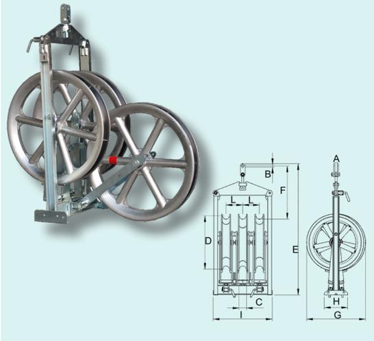
Polea descomponible de 3 ruedas para tendido de dos o tres conductores. El bastidor contiene 3 poleas simples que se pueden utilizar de forma individual. Ruedas de aluminio fundido montadas sobre cojinetes de bolas protegidos. Gargantas recubiertas por sectores en nylon. Bastidor de acero galvanizado con dispositivo anti-descarrilamiento sobre las ruedas laterales. Conector desmontable y orientable de 90°.
