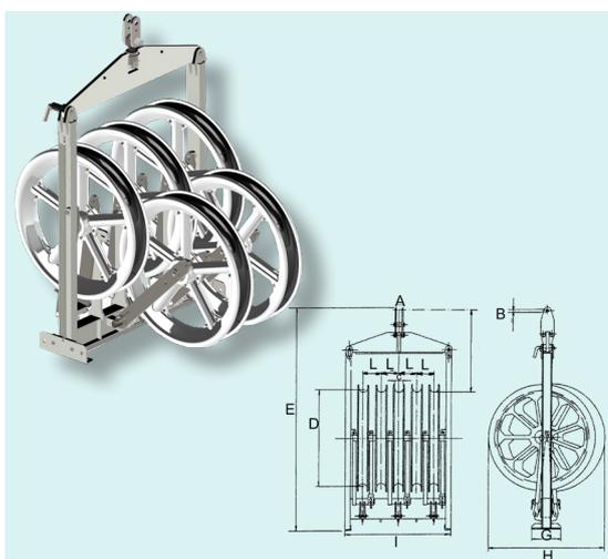
Carrucola scomponibile a 5 ruote per conduttori in fascio quadrinato. Nel telaio trovano posto 5 carrucole che possono essere estratte ed utilizzate singolarmente. Ruote in alluminio fuso montate su cuscinetti schermati. Gole rivestite in settori nylon. Telaio in acciaio zincato. Ruota centrale montata su doppi cuscinetti. Attacco smontabile e orientabile a 90°.
