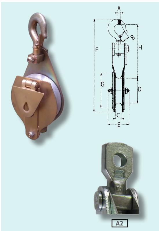
Poulie de renvoi de type ouvrant. Réa aluminium monté sur roulements à billes. Châssis en aluminium ouvrant d'un côté. Fixation à crochet standard.
