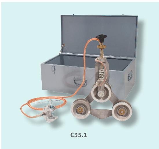
Dispositivo para la puesta a tierra durante el tendido de conductores desnudos aéreos o cables de tiro de acero. Las poleas de aleación de aluminio con cojinetes de bronce incorporados aseguran un buen deslizamiento y continuidad eléctrica. Resorte de compensación con rodillo regulable para un contacto seguro aún sobre conductores con empalmes.
