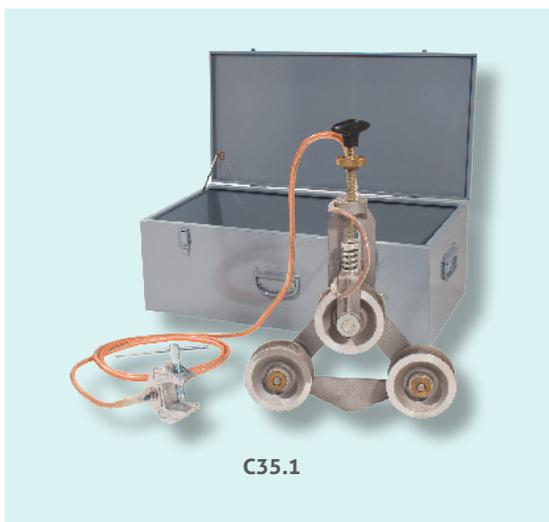
Dispositif de mise à la terre «roulante» utilisé pour la liaison à la terre de câbles aériens nus et de câbles acier pendant le déroulage. Les réas en alliage aluminium avec coussinets incorporés garantissent un bon niveau de glissement et une continuité électrique même aux points de jonction. Ressorts de contraste pour un contact sûr même sur les conducteurs avec manchon de jonction.
