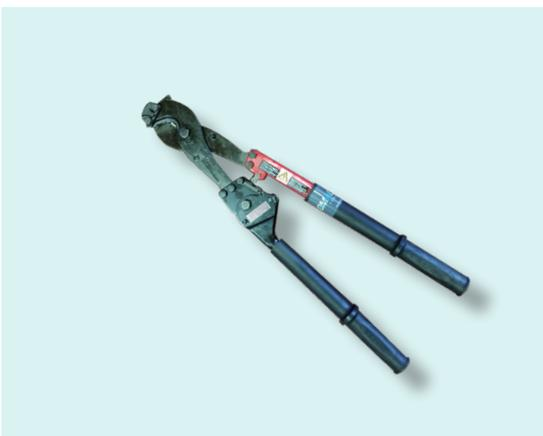
Cortadora de cremallera para conductores, cables e hilos de guarda. El sistema de cadena permite cortar el cable con el mínimo esfuerzo. Mangos aislados testeados a 20.000 Voltios.
