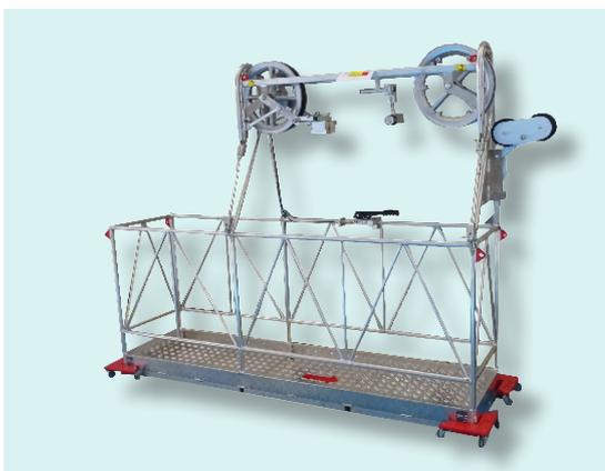
Carro de inspección para líneas eléctricas de conductor simple. Adecuado para 2 personas. Traslado por arrastre. Estructura de aleación ligera de aluminio con ruedas de nylon montadas sobre rodamientos de bolas. Freno de estacionamiento. Equipado de cuenta metros.
