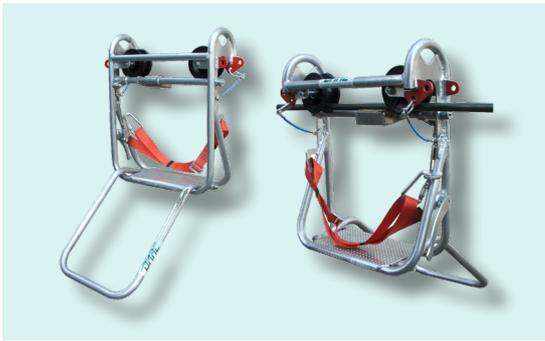
Carro de inspección monoplaza para líneas eléctricas de conductor simple. Traslado por arrastre. Estructura de aleación ligera de aluminio con ruedas de nylon montadas sobre rodamientos de bolas. Freno de estacionamiento. Cinta en nylon de apoyo posterior.
