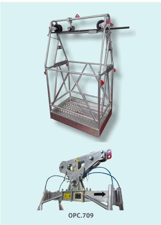
Carro de inspección para líneas eléctricas de conductor simple. Adecuado para 1 ó 2 personas. Traslado por arrastre. Estructura de aleación ligera de aluminio con ruedas denylon montadas sobre rodamientos de bolas. Freno de estacionamiento. Equipado de cuenta metros.
