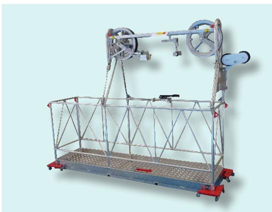
Carro de inspección para líneas eléctricas de conductor simple. Adecuado para 2 personas. Traslado por arrastre. Estructura de aleación ligera de aluminio con ruedas nylon montadas sobre rodamientos de bolas. Freno de estacionamiento. Equipado de cuenta metros.
