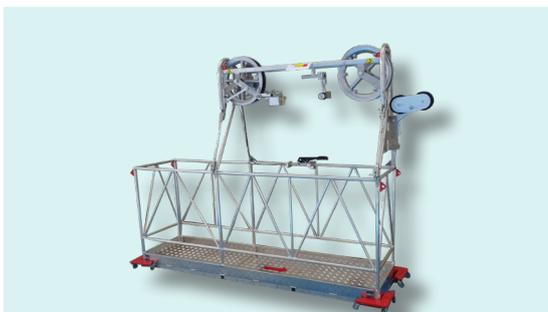
Nacelle pour lignes électriques à simple conducteur. Adaptée pour 2 personnes. Structure en alliage aluminium avec réas nylon montés sur roulements à billes. Frein de stationnement. Équipée de compteur de mètres.
