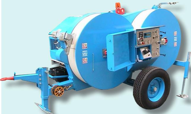
Freno hidráulico adecuado para tensar un conductor o cable de fibra óptica. Un circuito hidráulico permite ejecutar una fuerza de frenado constante aún al variar de la velocidad de tendido. Posibilidad de uso como cabrestante para recuperar conductores.
