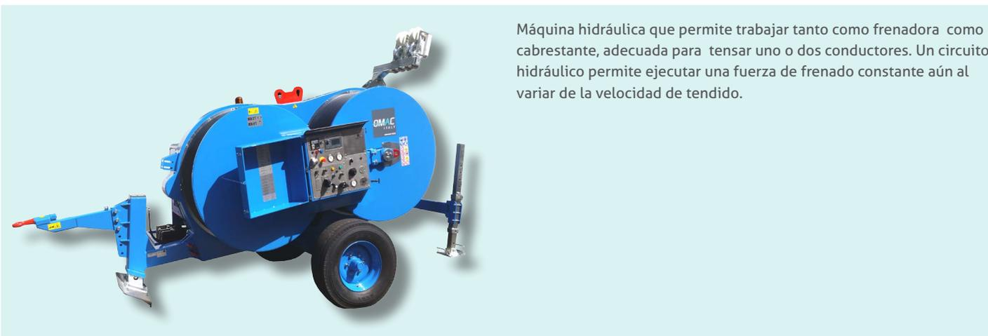
Máquina hidráulica que permite trabajar tanto como frenadora como cabrestante, adecuada para tensar uno o dos conductores. Un circuito hidráulico permite ejecutar una fuerza de frenado constante aún al variar de la velocidad de tendido.
