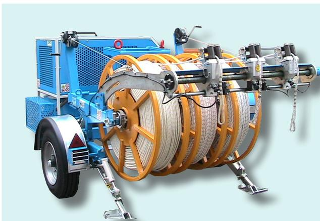
Carro motorizado para transporte de bobinas, diseñado para la recuperación y desembobinado de cables y conductores sobre bobinas de madera o acero. El carro puede aceptar hasta 3 ó 4 bobinas que, accionadas por un motor hidráulico, permiten tanto recuperar (uso cabrestante) como frenar (uso frenadora) cable/ conductor.
