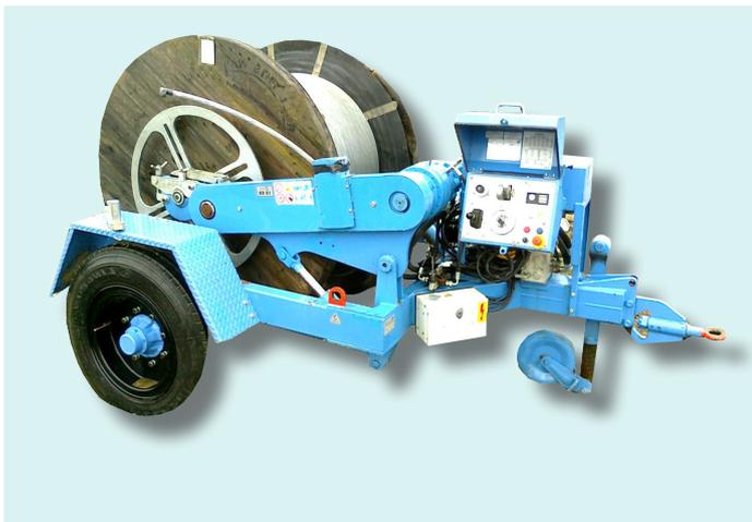
Carro portabobina diseñado para la recuperación/frenado de cables y conductores sobre bobinas de madera o acero. La bobina, accionada por un motor hidráulico, permite tanto recuperar (uso cabrestante) como frenar (uso frenadora) un cable o conductor.
