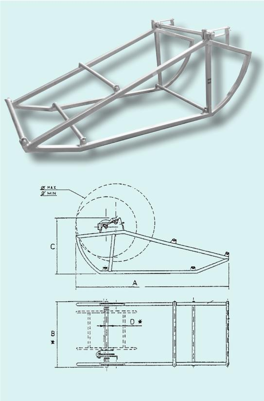
Caballote para elevar y desenrollar bobinas de cuerda de acero. Totalmente galvanizado. Completamente desmontable para facilitar el transporte. Incluido el eje porta bobina.
