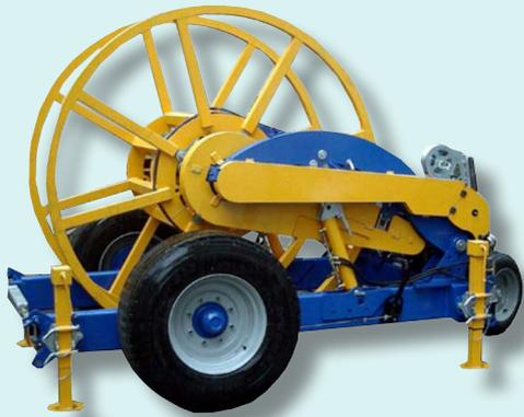
Rebobinadora diseñada para la recuperación/frenado de cables y conductores sobre bobinas metálicas. El accionamiento de la bobina y de circuito de cabrestante y freno hidráulico, se hace por medio de un motor hidráulico alimentado por unidad hidráulica, con conexión por mangueras flexibles.
