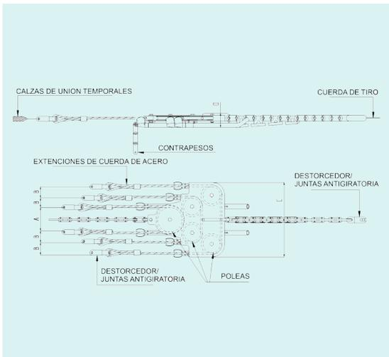
Reenvío para conductores séxtuples adecuado para conectar el cable de tiro a 6 conductores.
