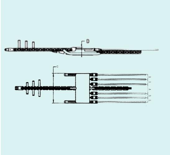
Reenvío fijo para conductores séxtuples adecuado para conectar el cable de tiro a 6 conductores.
