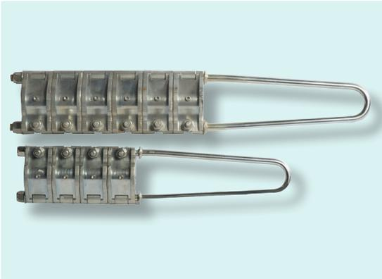
Rana tensora tipo "chambón" adecuada para el tense y el anclaje de conductores y cables de acero. Se compone de varios elementos de acero, con mordazas de aluminio (para conductores) o, según demanda, de bronce (para cables de acero).
