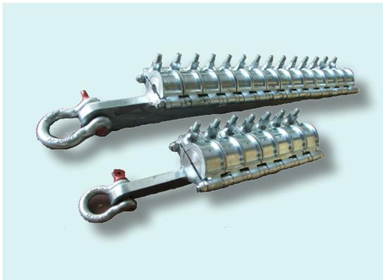
Rana tipo radial para conductores. Se compone de varios elementos de acero, con mordazas de aluminio (para conductores) o, a la demanda, de bronce (para cables de acero). Adecuado para conductores de aluminio y cables de acero hasta un diámetro máximo de 60 mm.
