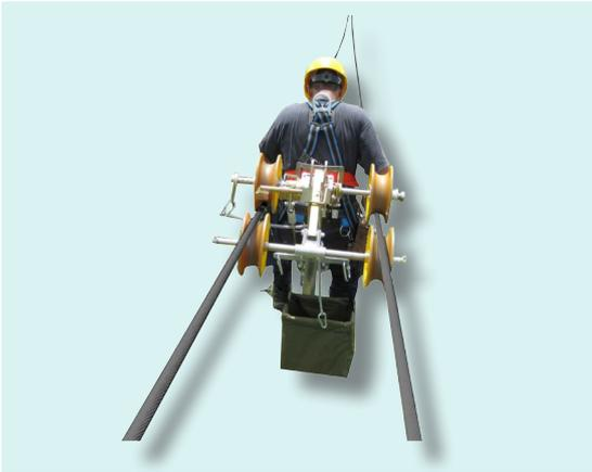
Bicicletas para líneas eléctricas de conductores simples, dobles, triples o cuádruples. Ruedas de nylon sobre cojinetes de bola. Adecuadas para moverse sobre conductores pedaleando como una bicicleta común. Equipada con freno de tipo disco y freno de seguridad de pinza que actúa directamente sobre el conductor, cinturón de seguridad y cuenta metros, pendiente máxima de la línea 25%.
