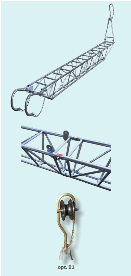
Escalera adecuada para trabajos de anclaje. Fabricadas de aleación ligera de aluminio, con peldaños de material antideslizante y ganchos de suspensión de acero galvanizado. La escalera incluye un gancho fijo para la torre, abertura 220 mm, y un gancho giratorio para apoyo sobre el conductor, que permite el uso en posición horizontal. Las escaleras son de sección trapezoidal.
