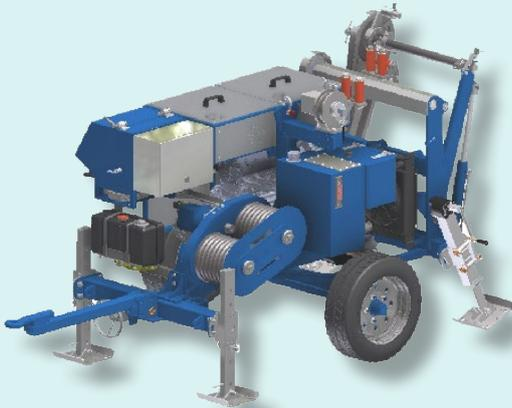
Treuil hydraulique conçu pour le tirage d'une câblette dans le déroulage de lignes électriques de transport aériennes. Un circuit hydraulique fermé permet de varier en continu la vitesse de rotation des cabestans dans les deux directions en agissant sur un seul dispositif de contrôle.
