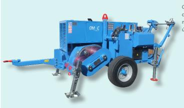
Cabrestante hidráulico adecuado para un cable de acero en el tendido de líneas aéreas. Un circuito hidráulico cerrado permite variar de manera continua la velocidad en ambos sentidos actuando sobre un único mando.
