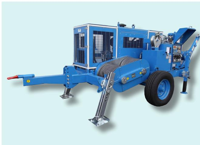
Treuil hydraulique conçu pour le tirage d'une câblette dans le déroulage de lignes électriques de transport aériennes. Un circuit hydraulique fermé permet de varier en continu la vitesse de rotation des cabestans dans les deux directions en agissant sur un seul dispositif de contrôle.
