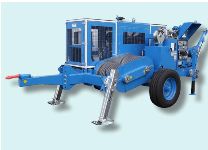
Cabrestante hidráulico adecuado para un cable de acero en el tendido de líneas aéreas. Un circuito hidráulico cerrado permite variar de manera continua la velocidad en ambos sentidos actuando sobre un único mando.
