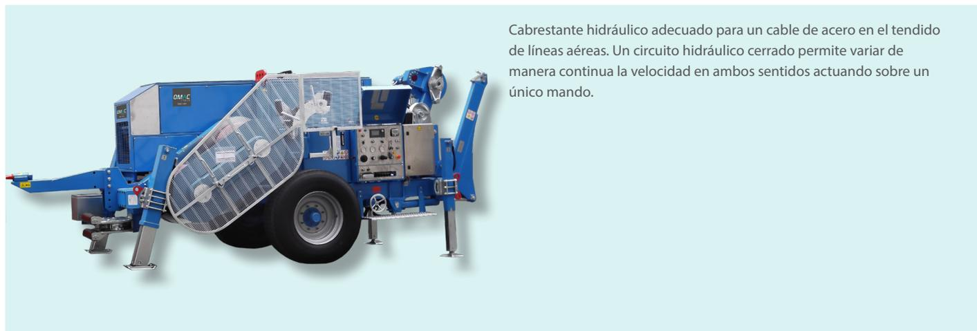
Cabrestante hidráulico adecuado para un cable de acero en el tendido de líneas aéreas. Un circuito hidráulico cerrado permite variar de manera continua la velocidad en ambos sentidos actuando sobre un único mando.
