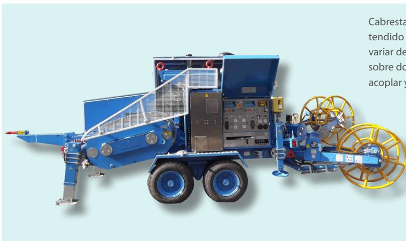
Cabrestante hidráulico adecuado para uno o dos cables de acero en el tendido de líneas aéreas. Dos circuitos hidráulicos cerrados permiten variar de manera continua la velocidad en ambos sentidos actuando sobre dos mandos independientes. Los dos circuitos se pueden acoplar y controlar juntos por un único mando.
