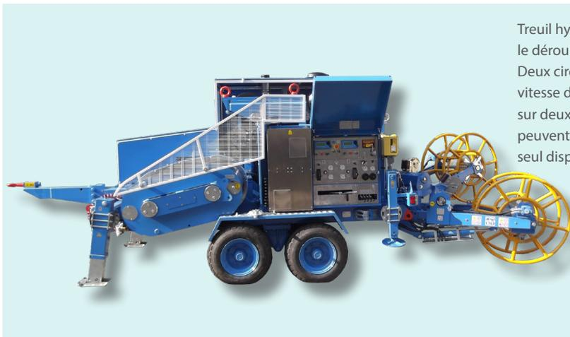
Treuil hydraulique conçu pour le tirage d'une ou deux câbles dans le déroulage de lignes électriques de transport aériennes. Deux circuits hydrauliques fermés permettent de varier en continu la vitesse de rotation des cabestans dans les deux directions en agissant sur deux dispositifs de contrôle indépendants. Les deux circuits peuvent être également jumelés et contrôlés simultanément par un seul dispositif de contrôle.
