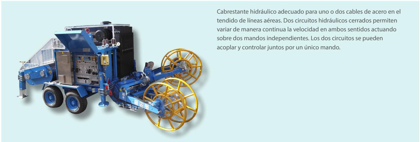
Cabrestante hidráulico adecuado para uno o dos cables de acero en el tendido de líneas aéreas. Dos circuitos hidráulicos cerrados permiten variar de manera continua la velocidad en ambos sentidos actuando sobre dos mandos independientes. Los dos circuitos se pueden acoplar y controlar juntos por un único mando.
