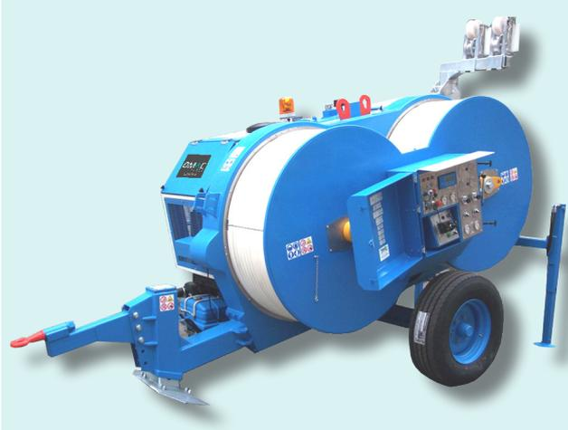
Freno hidráulico adecuado para tensar uno o dos conductores o cables de fibra óptica. Un circuito hidráulico permite ejecutar una fuerza de frenado constante aún al variar de la velocidad de tendido. Posibilidad de uso como cabrestante para recuperar conductores.
