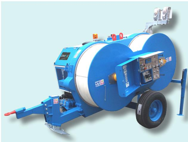
Freineuse hydraulique conçue pour l'installation d'un ou deux conducteurs ou câbles à fibre optique. Un circuit hydraulique permet d'appliquer une force de freinage constante même à la variation de la vitesse de déroulage. Possibilité d'utiliser la machine comme treuil pour la récupération des conducteurs.
