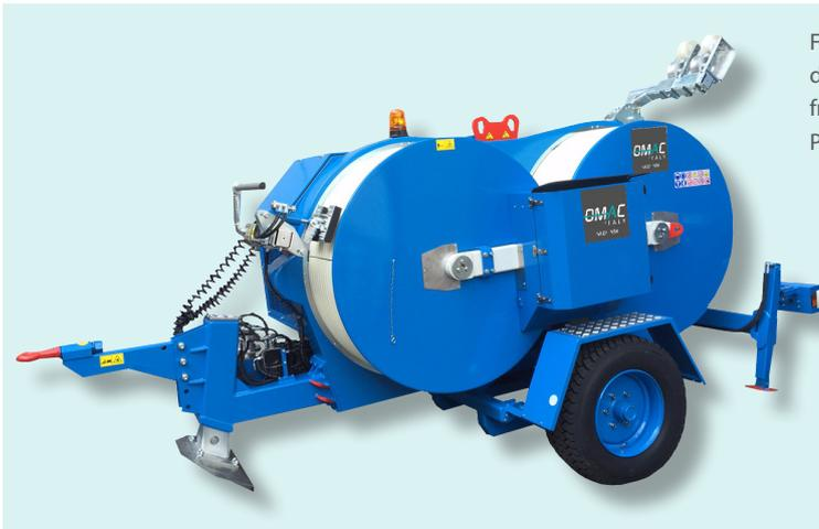
Freno hidráulico adecuado para tensar uno o dos conductores o cables de fibra óptica. Un circuito hidráulico permite ejecutar una fuerza de frenado constante aún al variar de la velocidad de tendido. Posibilidad de uso como cabrestante para recuperar conductores.
