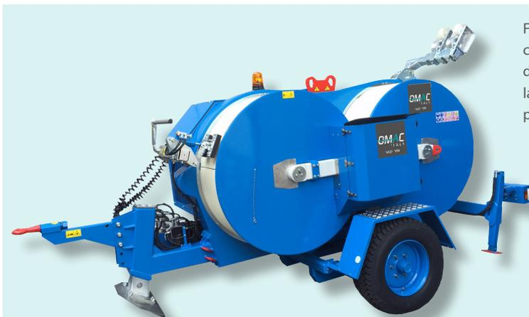
Freineuse hydraulique conçue pour l'installation d'un ou deux conducteurs ou câbles à fibre optique. Un circuit hydraulique permet d'appliquer une force de freinage constante même à la variation de la vitesse de déroulage. Possibilité d'utiliser la machine comme treuil pour la récupération des conducteurs.
