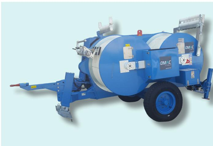
Freno hidráulico adecuado para tensar hasta seis conductores. Un circuito hidráulico permite ejecutar una fuerza de frenado constante aún al variar de la velocidad de tendido. Posibilidad de uso como cabrestante para recuperar conductores.
