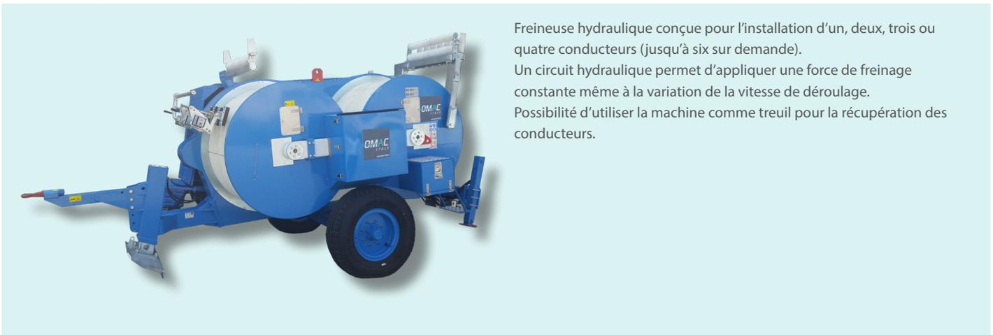
Freineuse hydraulique conçue pour l'installation d'un, deux, trois ou quatre conducteurs (jusqu'à six sur demande). Un circuit hydraulique permet d'appliquer une force de freinage constante même à la variation de la vitesse de déroulage. Possibilité d'utiliser la machine comme treuil pour la récupération des conducteurs.
