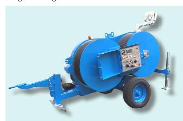
Machine hydraulique conçue pour travailler soit comme freineuse soit comme treuil, adaptée pour le tirage d'une ou deux câblettes ou pour le déroulage d'un ou deux conducteurs. Un circuit hydraulique permet d'appliquer une force de freinage constante même à la variation de la vitesse de déroulage. En fonction treuil, un circuit hydraulique permet de varier la vitesse dans les deux directions.
