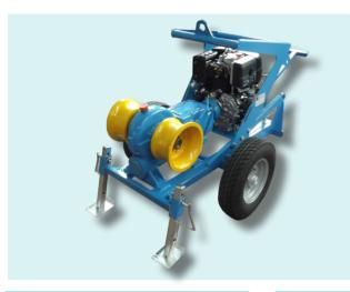
Treuil mécanique de service adapté pour le tirage d'une câblette lors des opérations de pose de câbles souterrains.
